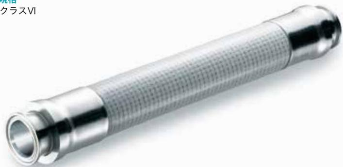
FDA・USPに適合した安全性の高いシリコンゴムを使用しています。中間層をポリエステル繊維ブレードとSUSワイヤーで補強することにより、負圧にも対応が可能になりました。
