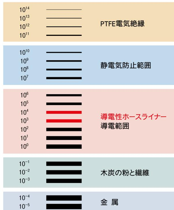
システムの中での物質の帯電される静電気の量は、自然環境により異なります。一般的には静電気の放出には、R122、R155、R160、R231、R233、R276のように、フッ素樹脂の内面にカーボンをコーティングしたホースを使用してください。
