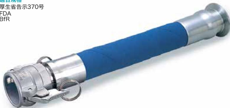
ホース内面にFDA・BfRに適合したホワイトEPDMゴムを使用しています。中間層をナイロン繊維ブレードとSSワイヤーで補強することにより負圧に対応可能です。外装材にはブルー EPDMゴムを使用しています。
