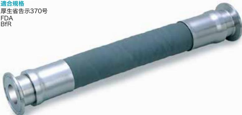
ホース内面にFDA・BfRに適合した耐油性・耐摩耗性が高いホワイトNBRゴムを使用しています。中間層をナイロン繊維ブレードとSSワイヤーで補強することにより負圧にも対応可能です。外装材にはグレーのクロロプレンゴムを使用しています。
