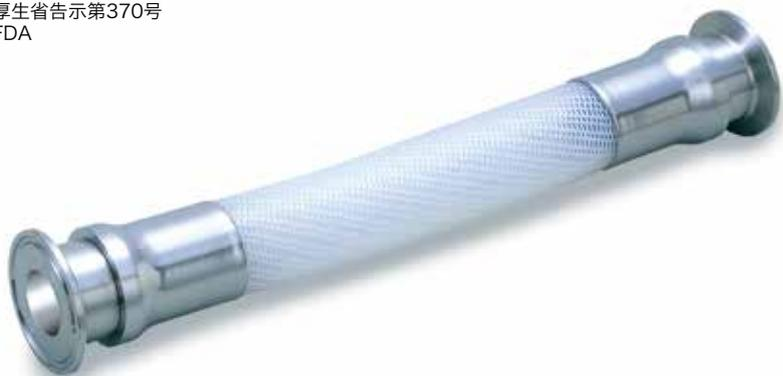
シリコンゴム単独では、耐圧ホースとしての強度がなく、シリコンの中間層をNTS構造のブレード（耐熱性強力合成繊維）で補強することにより、シリコンホースのよじれを制御しています。オプションとしてシリコンホースの外装にSUS製、PP製のブレードを補強することにより、耐圧性を高めることができます。ただし、負圧でのご使用はできません。
