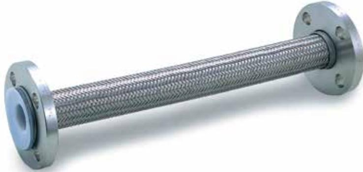
消防法評定品及び一般汎用品のSUS製フレキシブルホースの内面（接液部）をフッ素樹脂でフレア加工しています。
