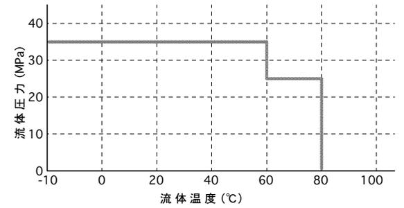
1注) 衝撃圧力が加わる場合(建設機械など)はピーク圧が上表の上限圧力を超えてはならない。
