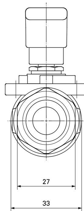
最高使用圧力 : 14 MPa max. (140 bar)
