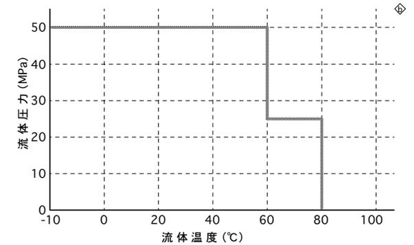
!注)衝撃圧力が加わる場合(建設機械など)はピーク圧が上表の上限圧力を超えてはならない。
